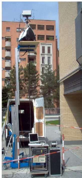
Attrezzatura in cantiere, in cui si nota la testa laser e il sistema di altoparlanti sul sistema di sollevamento, i dispositivi di controllo e registrazione dati a terra, contenuti in un rack standard
